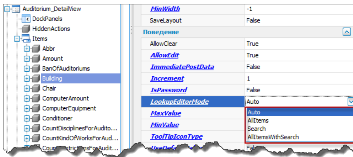
Рис. 56. Режимы отображения форм для выбора
