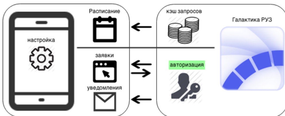
Рис. 77. Схема информационного взаимодействия
